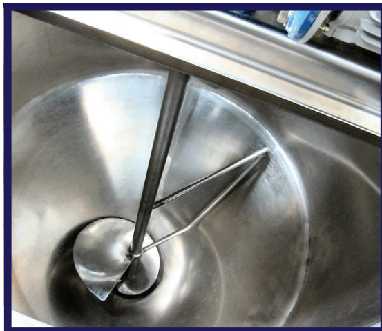
Elica conica ed aspo per prodotti densi ed alimentatori
