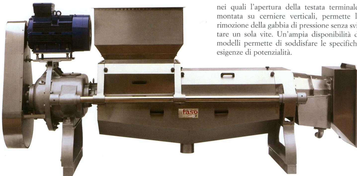
nei quali l'apertura della testata terminale, montata su cerniere verticali, permette la rimozione della gabbia di pressione senza svitare un sola vite. Un'ampia disponibilità di modelli permette di soddisfare le specifiche esigenze di potenzialità.
