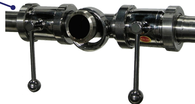
Particolare gruppo di distribuzione scarico prodotto filtrato
